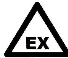
Zona con riesgos de atmósferas explosivas
